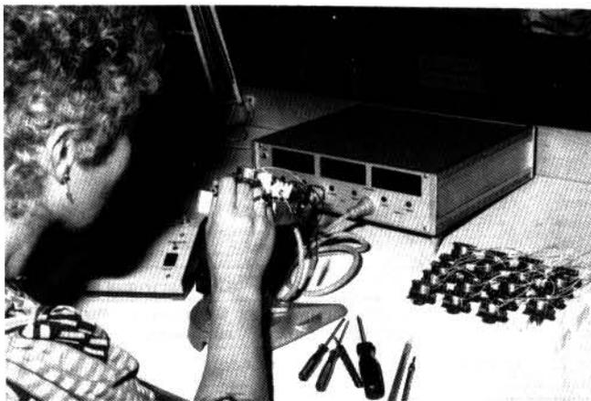
Réglage unitaire des tensions d'action et de relachement des relays 18 GHz.
